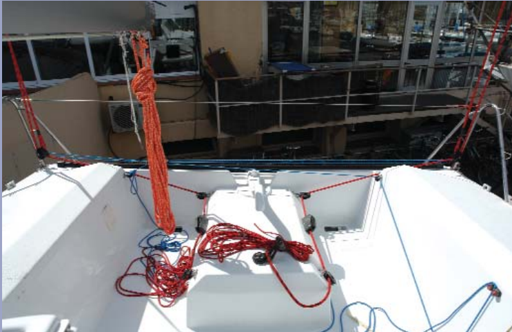
El carro de mayor va de banda a banda por popa para optimizar su reglaje y permitir la máxima longitud de la botavara. Las burdas se regulan con los cabos rojos ubicados a cada lado de la caña para facilitar su cazado al virar.
