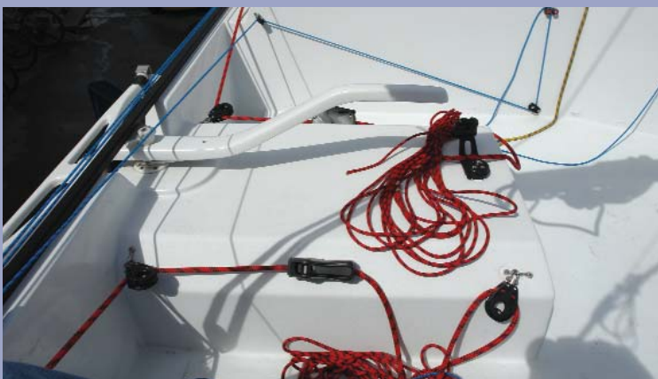
El carro de mayor va de banda a banda por popa para optimizar su reglaje y permitir la máxima longitud de la botavara. Las burdas se regulan con los cabos rojos ubicados a cada lado de la caña para facilitar su cazado al virar.
