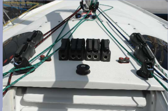
En la unidad fotografiada aún no estaba instalada toda la maniobra, pero se puede ver claramente que la cantidad de mordazas permiten enviar al piano todas las drizas, el pajarín, la contra y el baby que se utiliza en las ceñidas.
