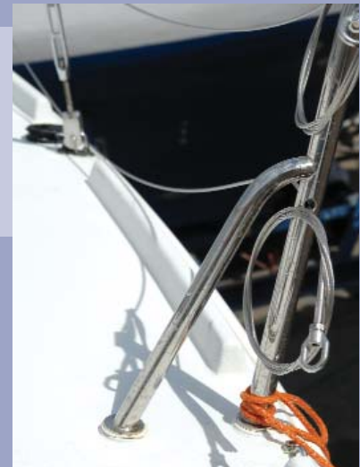
Los candeleros dobles son pasantes para brindar puntos de agarre más seguros al navegante.
