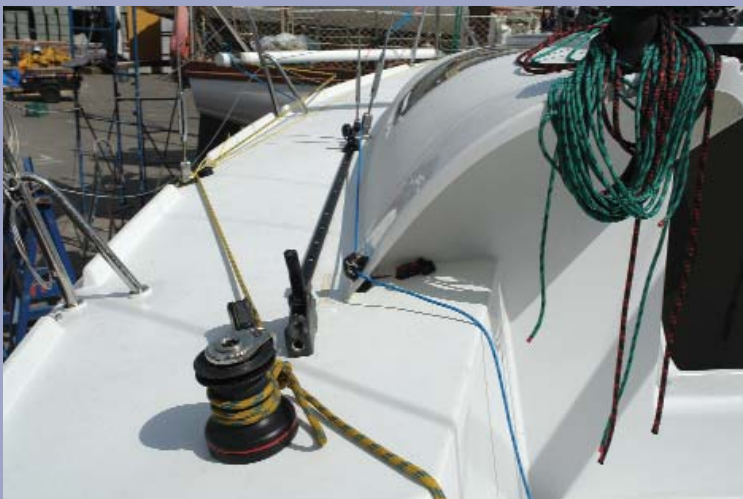
El cadenote del obenque alto va junto a la borda, los de los bajos junto a la caseta para permitir el paso del génova entre ellos, reduciendo el ángulo de ceñida.
