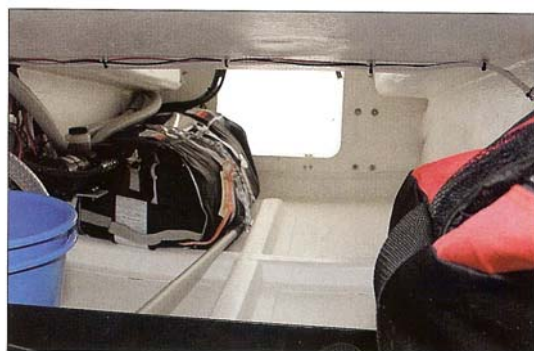
Habitáculo por donde salir en caso de emergencia. Al fondo, en el espejo de popa junto a la balsa, la escotilla que la Clase Mini exige.
