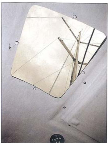
A través de uno de los dos portillos se ven los dos pisos de crucetas retrasadas de diferente tamaño. Posee dos burdas y un babystay, además de un botalón giratorio que se repliega a la banda.
