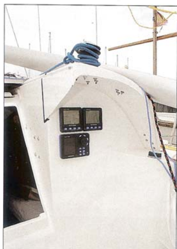
Un pequeño vierteaguas protege algo más a la persona que se sienta debajo y a la electrónica.
