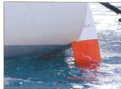
Los timones son más ligeros y fuertes gracias al uso de la espuma expansiva de epoxi.
