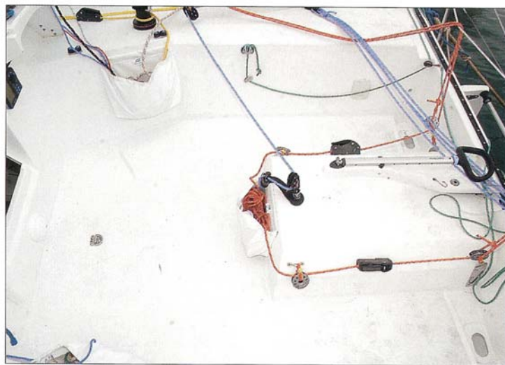
Las burdas también se han centrado y se arraigan a banda y banda de la "caja" que cubre la salida de emergencia.
