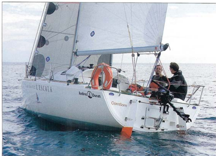
Efectivo sistema de quita y pon desarrollado por Indena para colocar en el centro el fueraborda.
