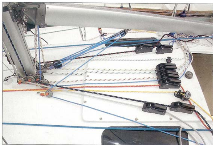
La maniobra ha sido meticulosamente rediseñada. La posición de la entrada permite insertar la relinga en el palo con una mano mientras se iza la mayor.
